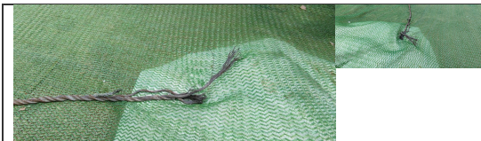
图13 西侧工作钢丝绳断口-1
