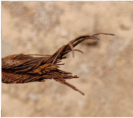
图12 东侧工作钢丝绳断口（侧视）
